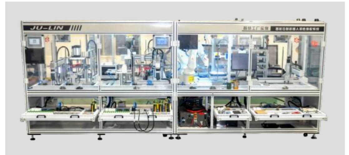
系统以完成一个较为复杂旋转笔筒作为生产制造载体，使用多工位组合式系统完成万花旋转笔筒生产装配。载体设计组装的自动化生产实践教学工程模块，以多个工位联网集成，装置下方安装有控制器可供学员学习安装接线及控制训练。
